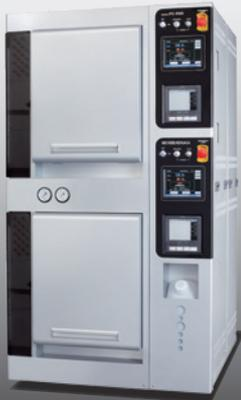
HAST装置で上下2段に試験槽を設けたPC-R9Dシリーズが新登場。
