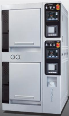
HAST装置で上下2段に試験槽を設けたPC-R9Dシリーズが新登場。上下独立式のため異なる試験も同時に評価ができ作業の短縮化がはかれます。最新の温湿度プログラムコントローラーも搭載し高精度の加速評価も実現。是非、展示会場でご覧ください。
